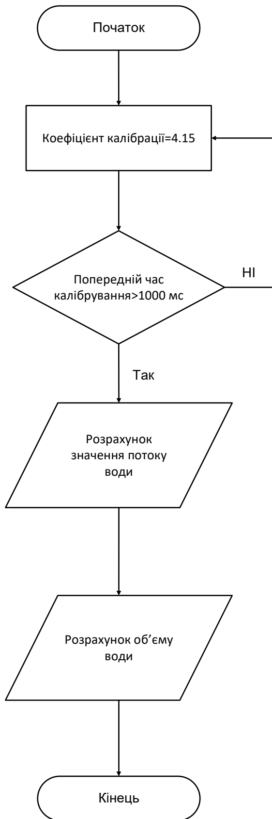
Рисунок 3.15 – Блок-схема алгоритму калібрування сенсора потоку води
