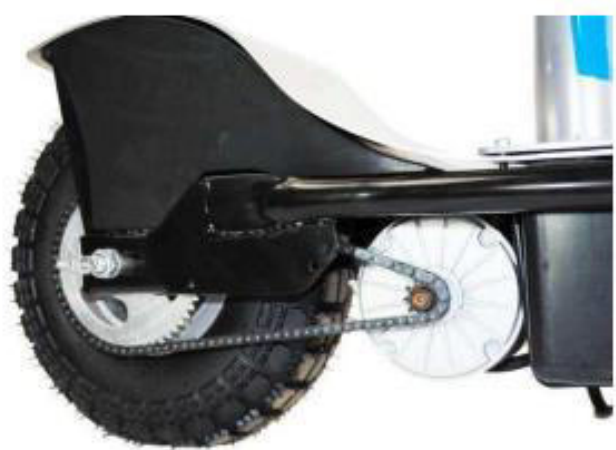
Рисунок 1.3 – Електросамокат з ланцюговим приводом
