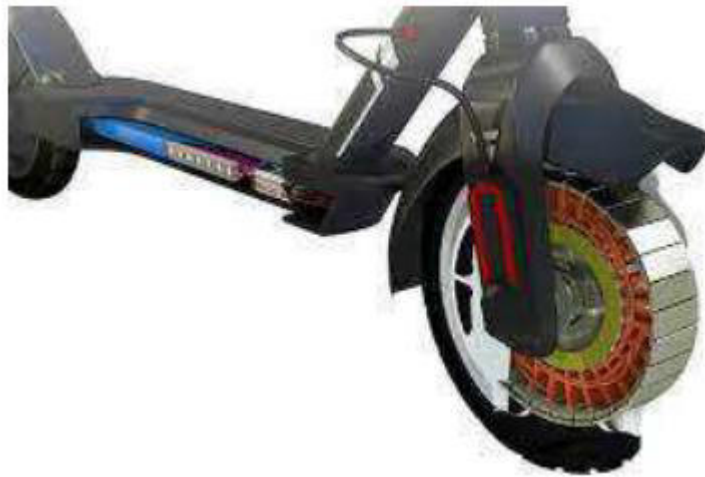
Рисунок 1.4 – Електросамокат із приводом на двигун-колесі
