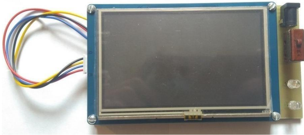
Рисунок 3.9 – Зібраний велокомп'ютер вид зверху
