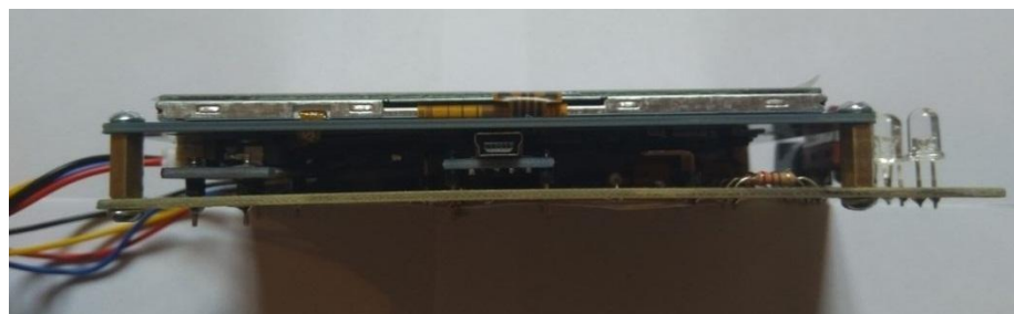
Рисунок 3.10 – Зібраний велокомп'ютер вид збоку
