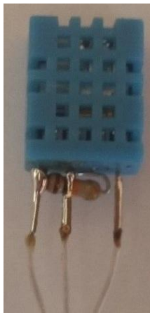
Рисунок 3.13 – Датчик температури із встановленим резистором
