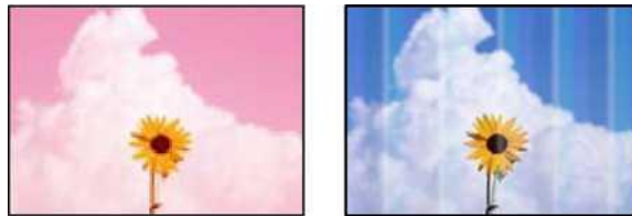
Рисунок 2.9 – Відсутній колір, вертикальні смуги
