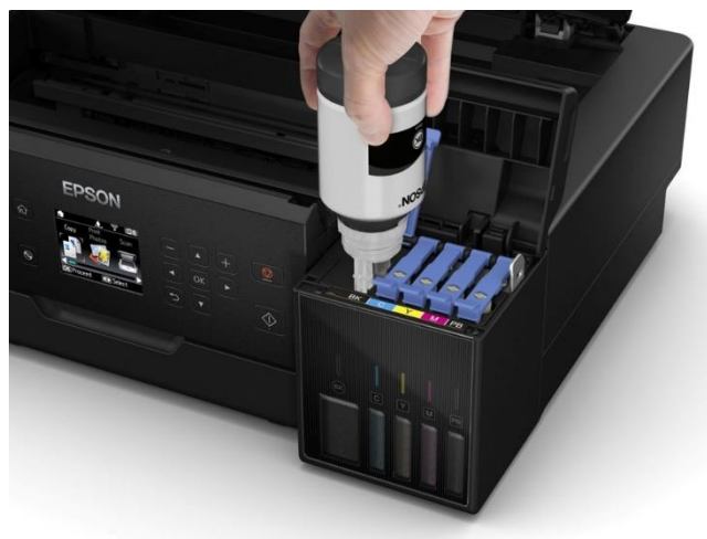
Рисунок 1.8 – Система KeyLock під час заправки чорнильних контейнерів
