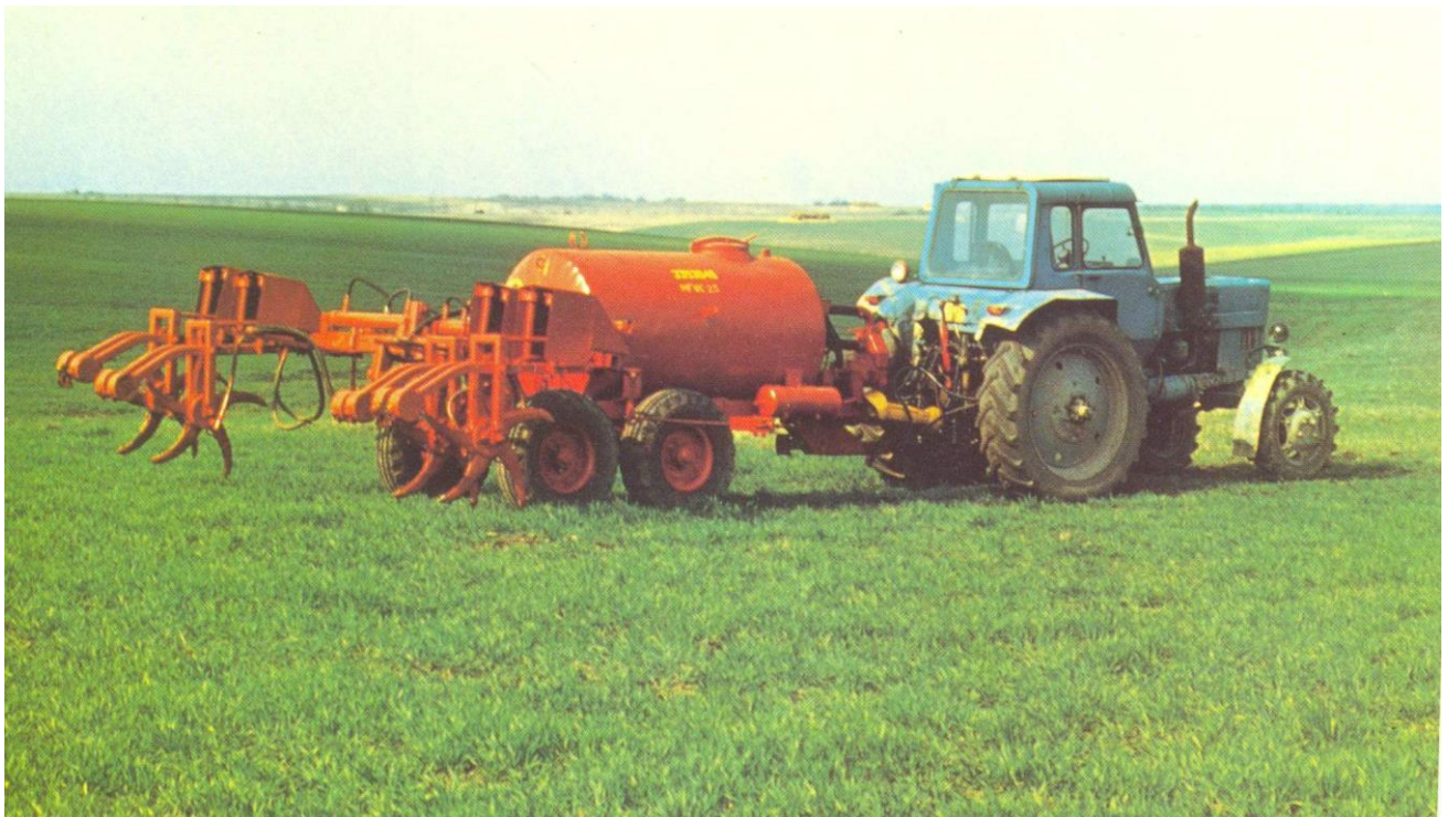
Рисунок 1.3 – Машина для глибокого внесення рідких мінеральних добрив в садах МГУС – 2,5
