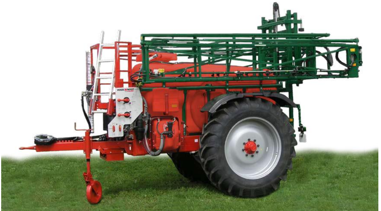
Рисунок 1.7 – Причіпні обприскувачі IN 280, IN 360 та IN 460 системи Holder виробництва VOGEL&NOOT (Австрія)
