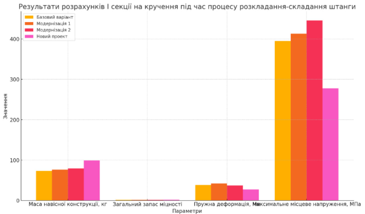
Рисунок 3.4 – Результати розрахунків на на кручення I секції при розкладанні секції
