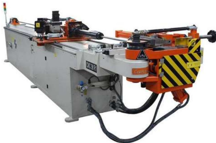
Рисунок 2.7 – Дорновий трубозгинальний верстат Cansa CNC38 R1 [10]
