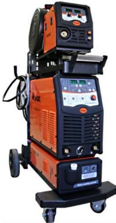
Рисунок 2.3 – Загальний вигляд напівавтомата Jasic MIG-350P [7]
