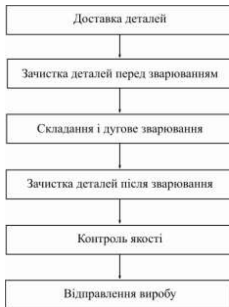
Рисунок 2.5 - Схема технологічного процесу виготовлення корпусу вогнегасника ВП-3
