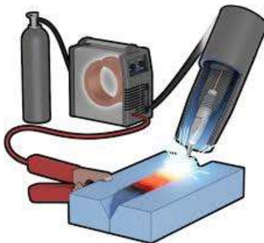
Рисунок 2.1 - Схема напівавтоматичного зварювання в захисних газах
