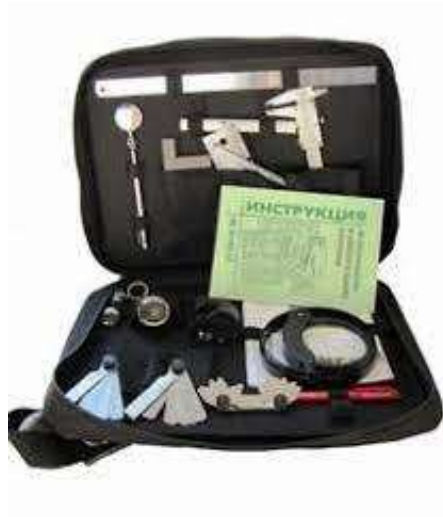
Рисунок 2.5 – Загальний вигляд комплекту для візуально-оптичного контролю Novotest VT-1 [9]
