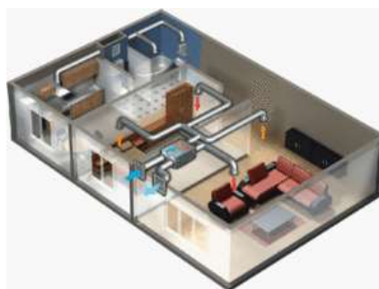
Рисунок 5.3 – Схема припливно-витяжної вентиляції
