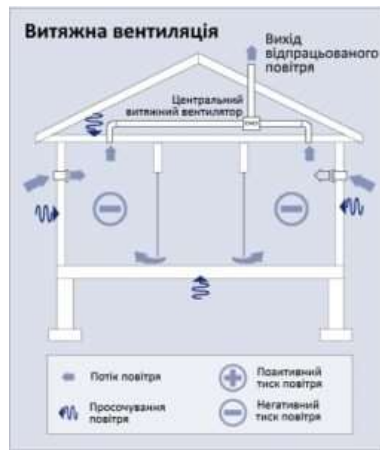
Рисунок 5.1 – Схема витяжної вентиляції
