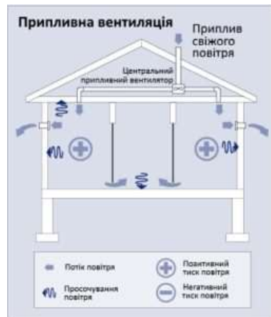
Рисунок 5.2 – Схема припливної вентиляції
