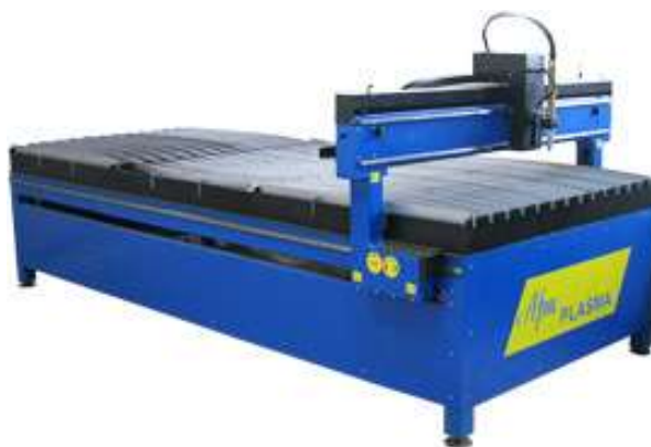
Рисунок 2.5 – Установка плазмового різання MaxPro 200 [10]
