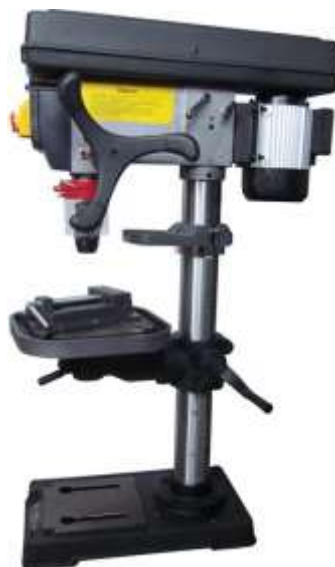
Рисунок 2.6 – Загальний вигляд свердлильного верстату Vulkan VLK-20T1 [10]
