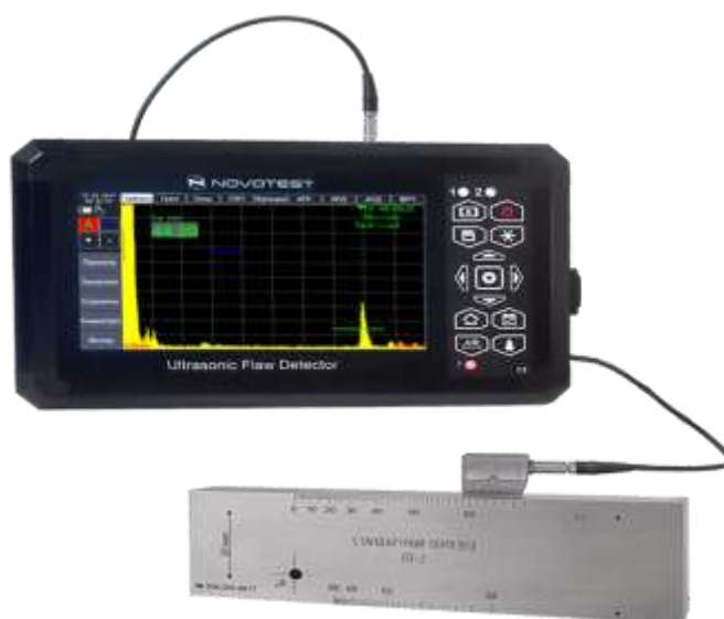
Рисунок 2.6 – Ультразвуковий дефектоскоп УД3701 [9]
