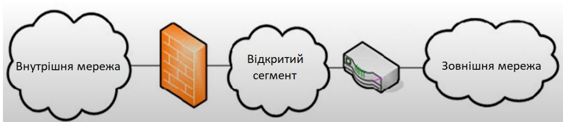
Рисунок 2.3 - Схема підключення МЕ з двома мережевими інтерфейсами при виділенні відкритого сегмента внутрішньої мережі
