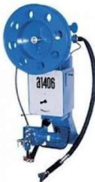
Рисунок 2.3 – Загальний вигляд зварювального автомата А-1406 [7]
