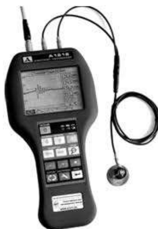
Рисунок 2.8 – Дефектоскоп ультразвуковий A1212 Master [13]
