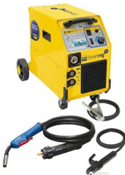
Рисунок 2.3 – Загальний вигляд зварювального напіваавтомата GYS SMARTMIG 3P [7]
