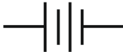
Рисунок 2.27 – Літієвий акумулятор та його умовне позначення на схемі
