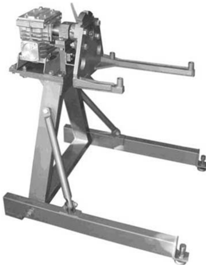
Рисунок 3.3- Стенд для автомобільних агрегатів ЛПН-078.00.000
