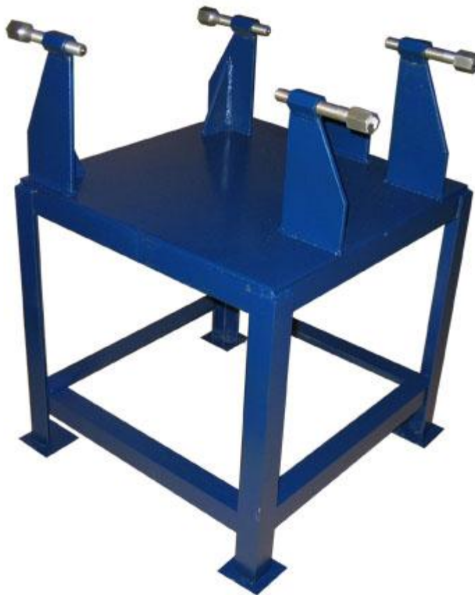
Рисунок 3.1 – Стенд для фіксації КПП під час ремонту
