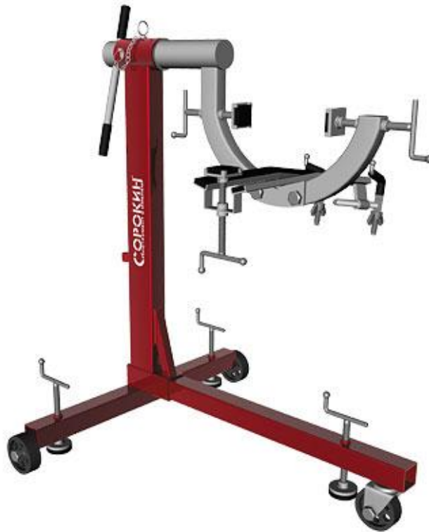
Рисунок 3.4 - Загальний вигляд стану для розбирання КПП
