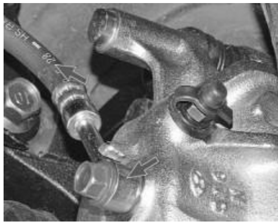
Рисунок 2.21 – З'єднання гальмівного шланга з гальмівним супортом
