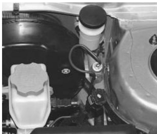
Рисунок 2.18 – З'єднання трубопроводів з головним гальмівним циліндром
