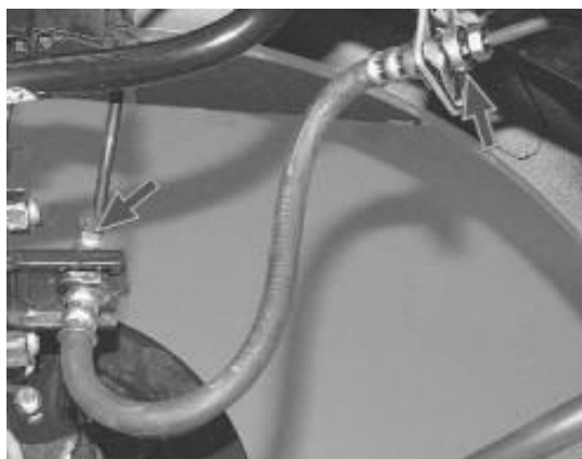
Рисунок 2.19 – З'єднання гальмівного шланга з гальмівними трубками
