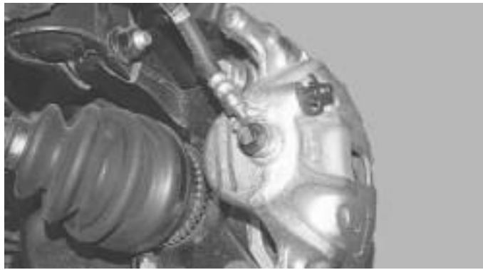
Рисунок 2.20 – З'єднання гальмівного шланга з гальмівним супортом
