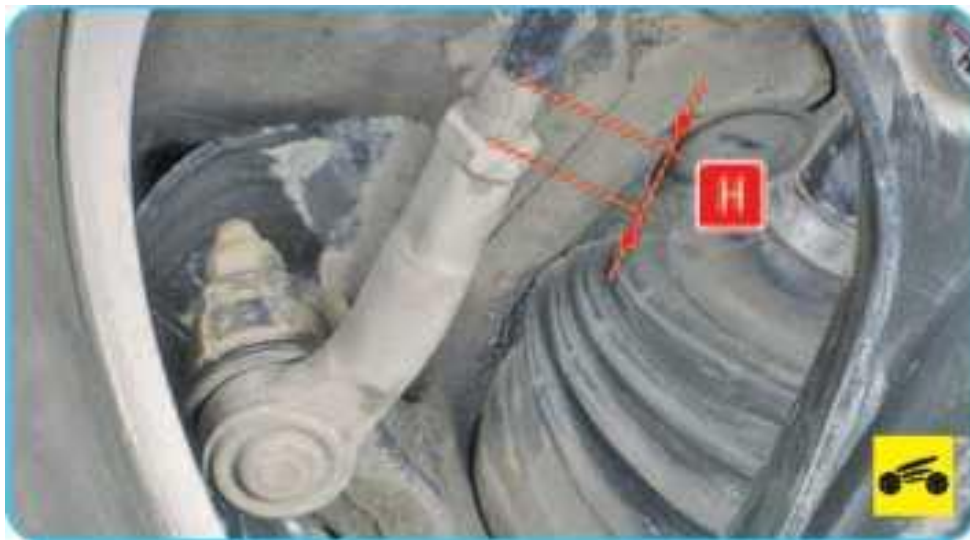
Рисунок 2.5 – Довжина різьби рульової тяги
