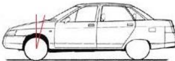
Рисунок 2.13 – Схематичне зображення кута кастера коліс
