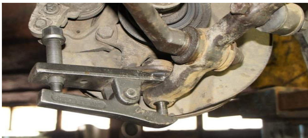
Рисунок 2.22- Випресування шарової опори універсальним знімачем
