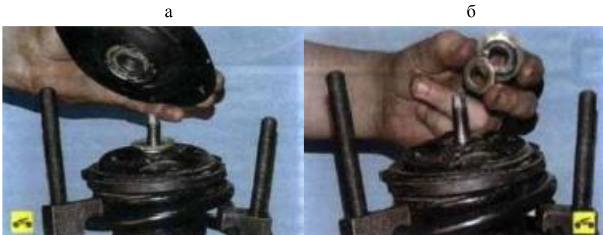
Рисунок 2.18- Схема знімання верхньої опори та шайб.
