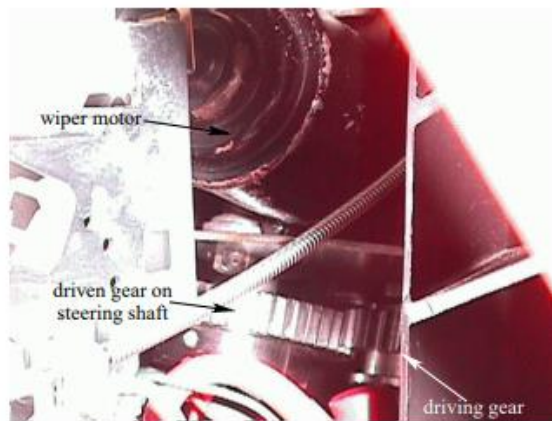
(а) Вид збоку на систему керування рульовим керуванням
