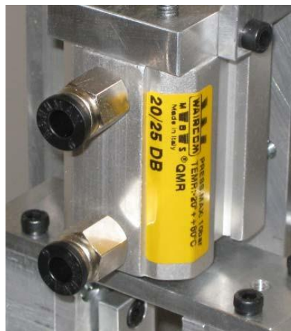
Рисунок 2.11 - Вибраний пневматичний циліндр для утримання захвату
