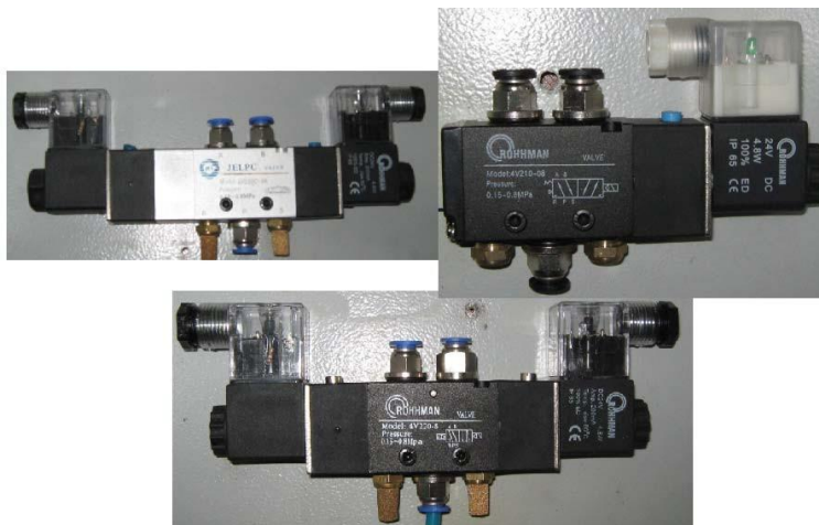
Рисунок 2.15 - Вибрані пневматичні клапани для застосування
