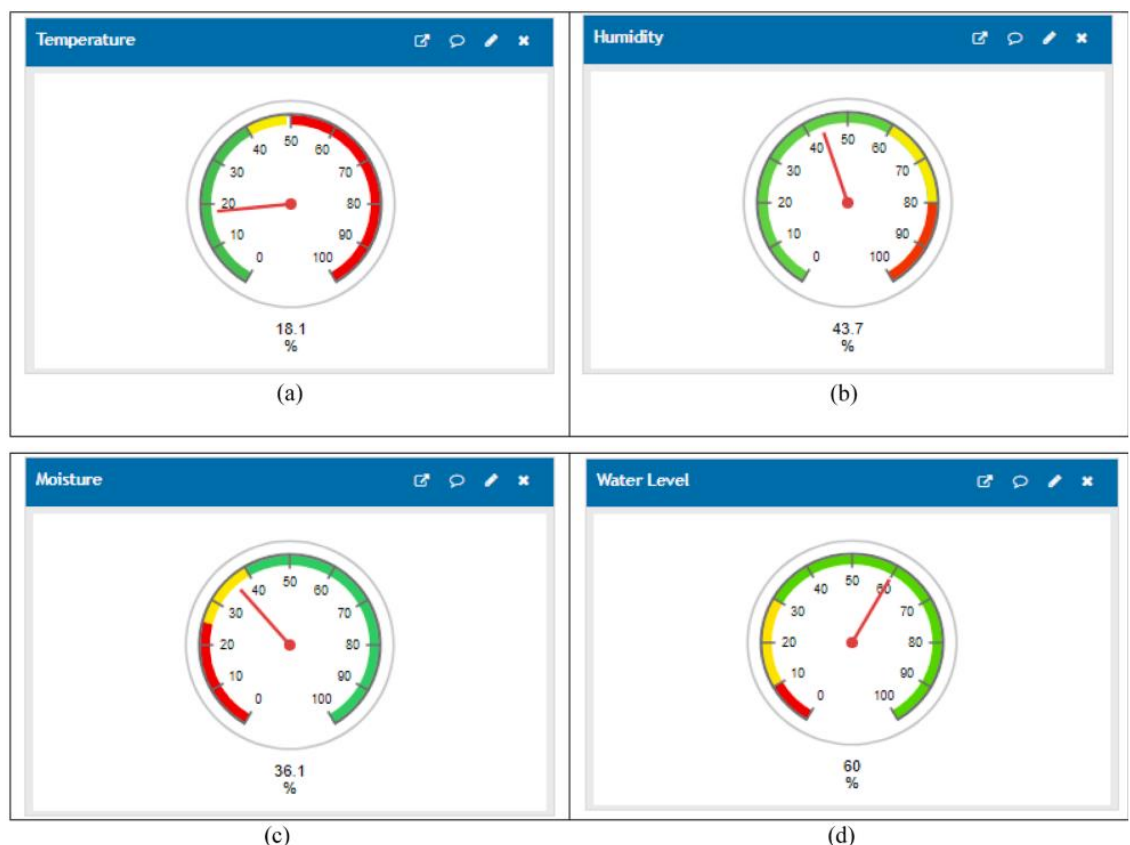
Рисунок 2.12 – Графічні віджети відображення даних в системі розумного поливу забезпечують легкий доступ до візуального представлення вимірних і оброблених даних на каналах ThingSpeak. Віджети датчиків включають, відповідно, (a) температуру, (b) вологість, (c) вологість і (d) рівень води.
