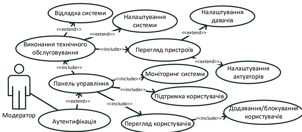
Рисунок 2.8 – Діаграма прецедентів ролі модератор інформаційної системи спостереження внутрішнього середовища «розумних приміщень»
