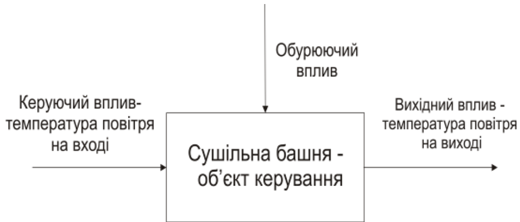
Рис. 2.14 -Параметрична схема сушильної вежі в еквівалентному вигляді.
