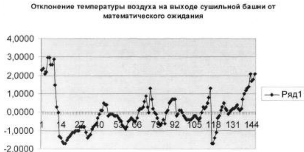
Рис. 2.11 -Цей графік показує різницю між температурою повітря на виході з сушильної вежі та середньою температурою.
