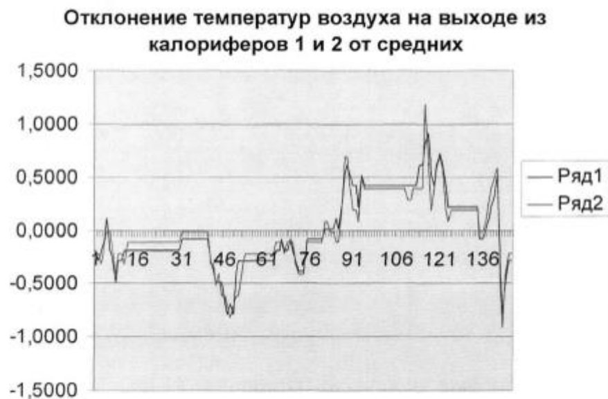
Рис. 2.7 -Графіки відхилень температур вихідного повітря з калориферів №1 та №2 від середніх значень.
