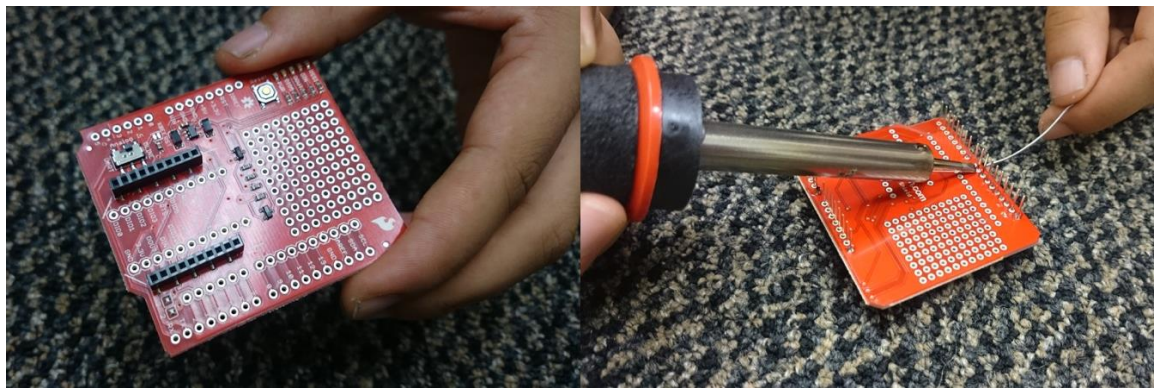
Рисунок 2.14 - Припаювання роз'ємів до екрану XBee для Arduino.
