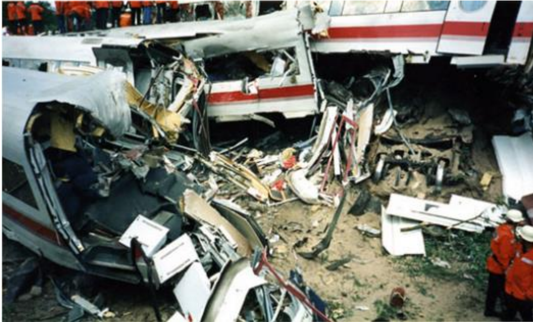
Рис. 1.1 – Залізнична аварія внаслідок розриву обода колеса [1]
