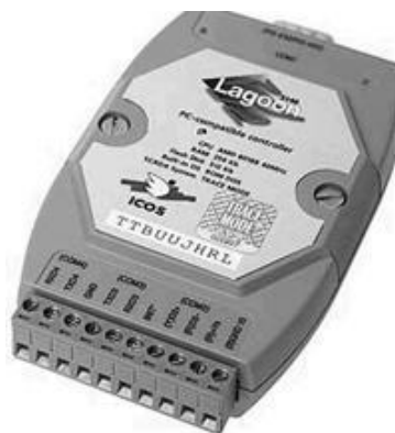
Рис. 2.10. Промисловий контролер Lagoon-3140
