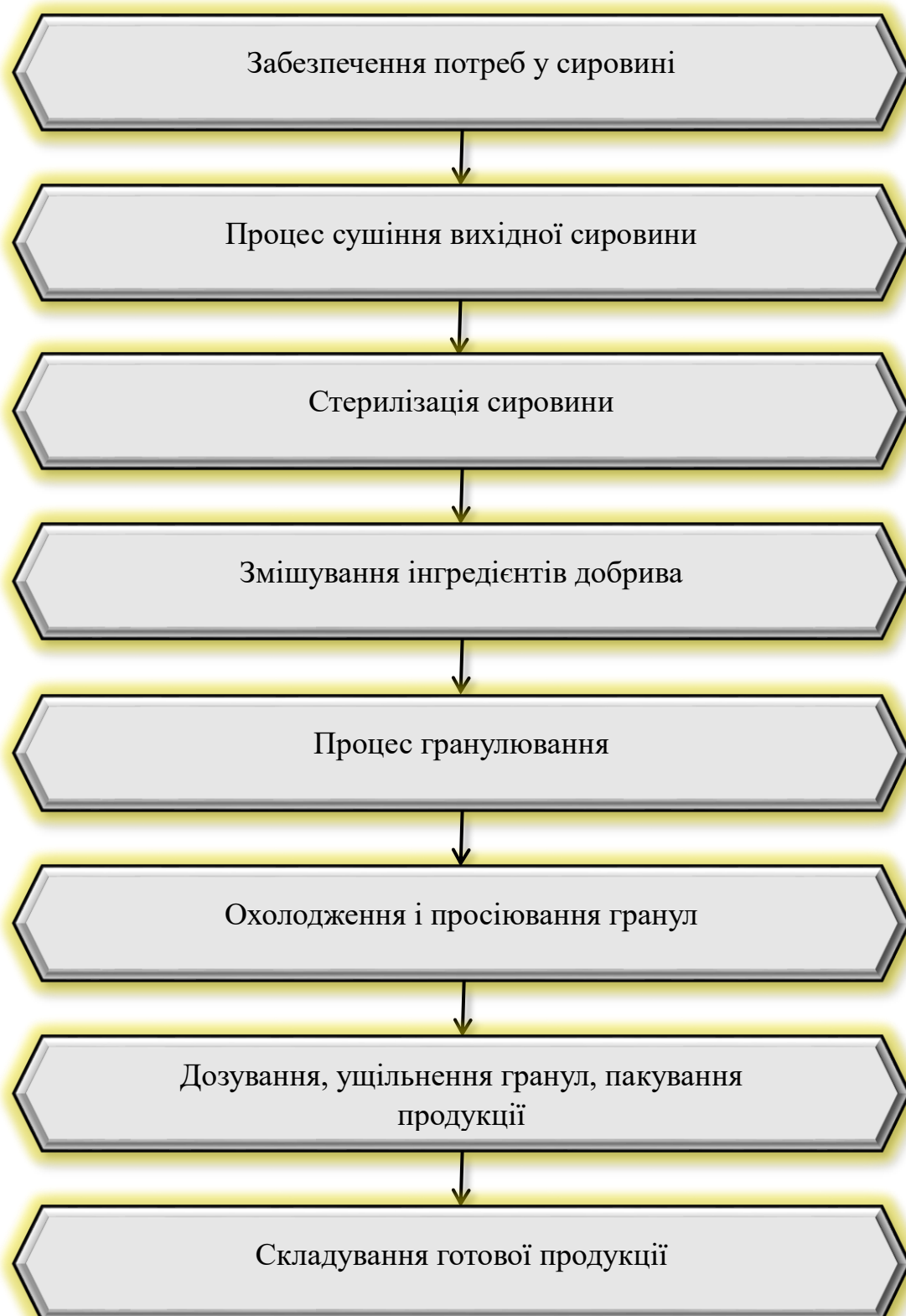
Рисунок 3.2 – Основні етапи пропонованого процесу виробництва органічних добрив із курячого посліду на ТОВ «Білий Берег»
