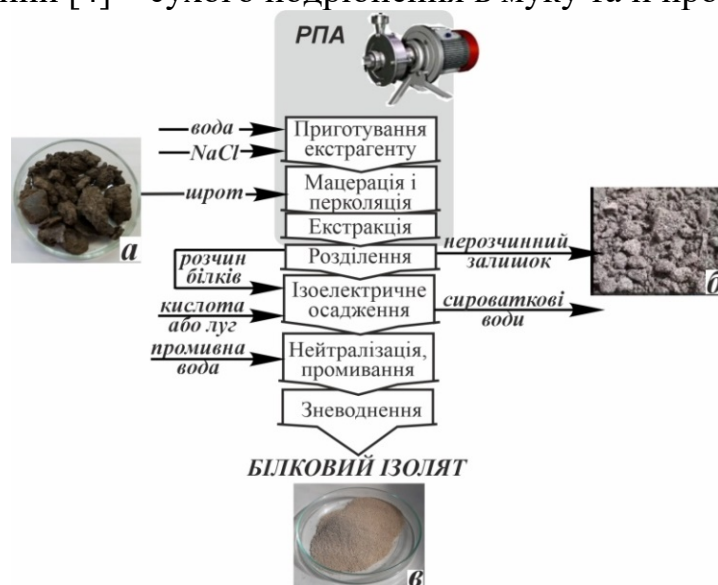
Рис.1. Блок-схема технології отримання білкових ізолятів зі шротів олійних культур; шрот, відходи й білковий ізолят з насіння соняшника (а-в).
