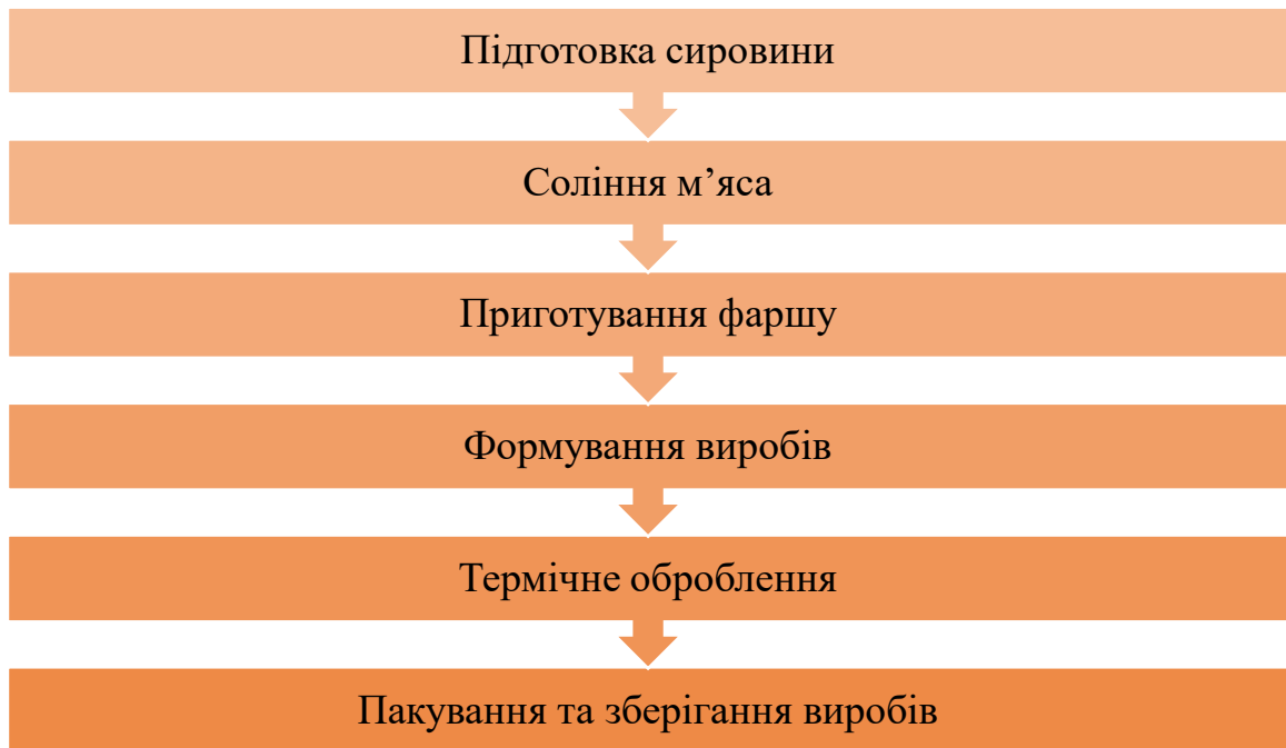
Рисунок 3.1 - Стадії технологічного процесу виробництва курячих сосисок
