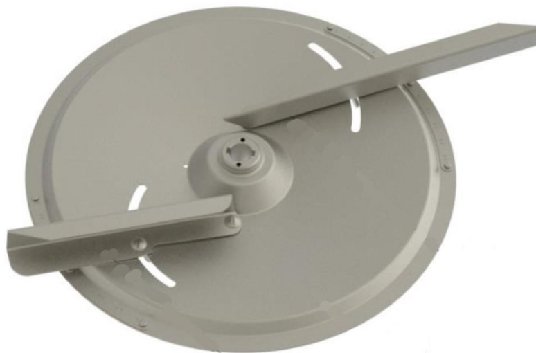
Рисунок 4.1 Небезпечна зона механізму розкидання добрив
