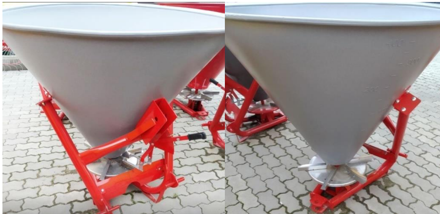
Рисунок 1.5 – Однодисковий розкидач за принципом відцентрової дії НРУ-6
