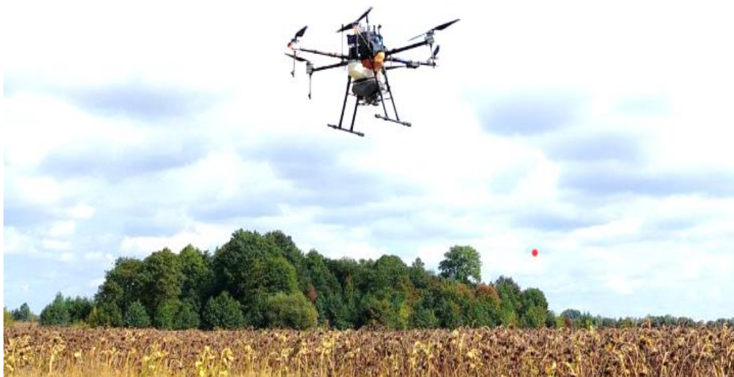
Рисунок 1.3. – Аграрний мультидрон (гібридний) UAS-25G
