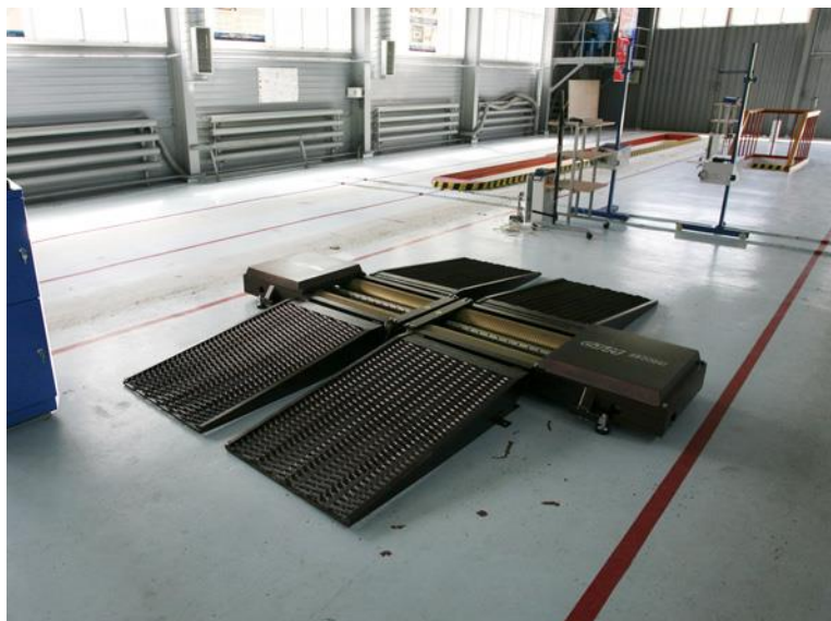
Рисунок 3.1 – Стенд для перевірки ефективності гальмівної системи
