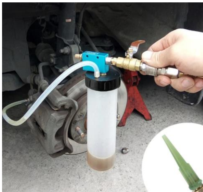
Рисунок 2.10 – Прокачування системи за допомогою станда
