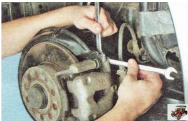
Рисунок 2.16 – Відкручування болтів направляючих пальців
