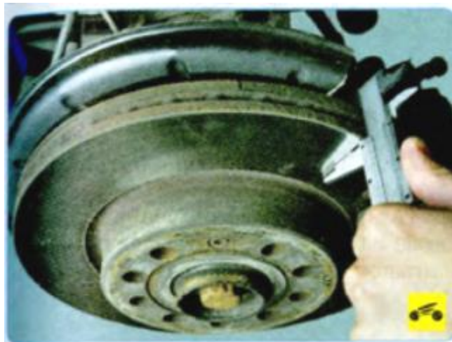
Рисунок 2.5 – Вимірювання товщини гальмівного диска
