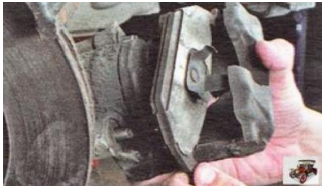
Рисунок 2.14 – Зняття зовнішньої колодки
