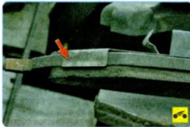
Рисунок 2.3 – Механічний сигналізатор граничного зносу накладки
