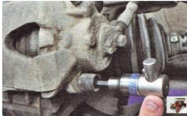
Рисунок 2.12 – Відкручування направлячого пальця
