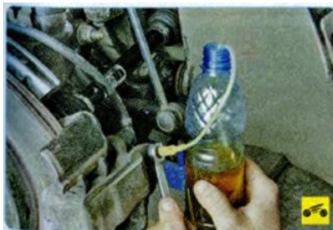
Рисунок 2.9 – Процес заміни рідини (прокачування гальм)
