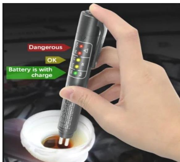
Рисунок 2.8 – Прилад для перевірки вмісту вологи в гальмівній рідині
