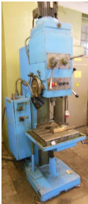
Рисунок 1.3 Вертикально-свердильний верстат 2Н125
