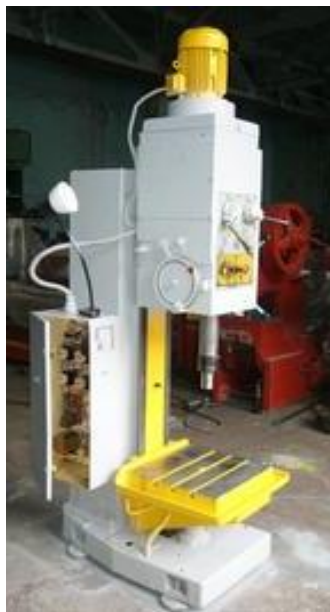
Рисунок 1.2 - Вертикально-свердильний верстат 2Н118
