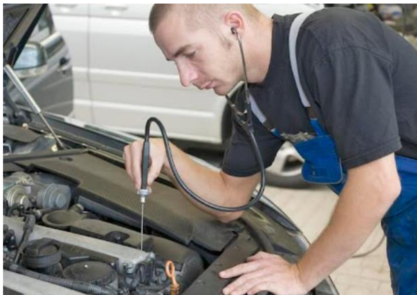
Рисунок 1.8 – Діагностування стуків за допомогою стетоскопа
