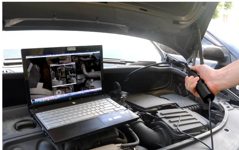
Рисунок 1.9 – Огляд двигуна відеоендоскопом
