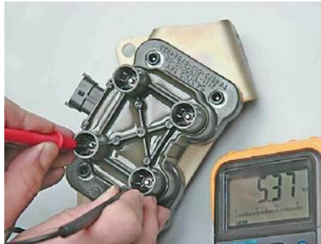
Рисунок 2.9 – Вимірювання опору вторинних обмоток
