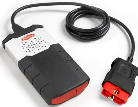
Рисунок 3.4 - Діагностичний сканер DELPHI DS150
