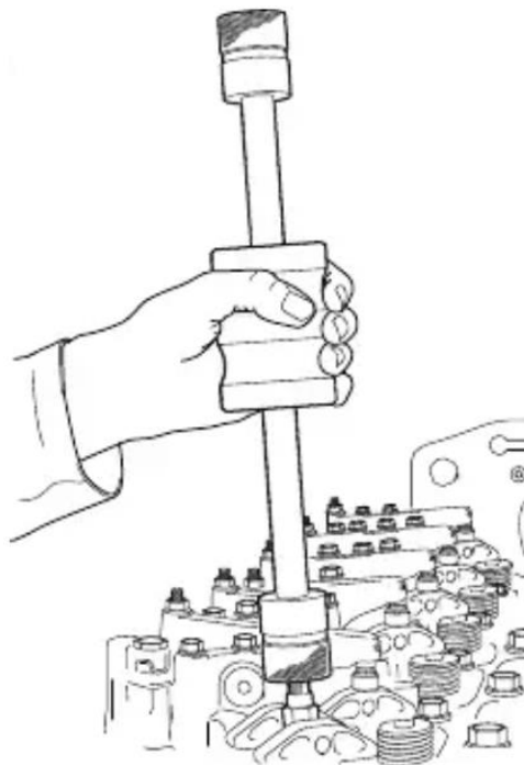
Рисунок 2.4 – Зняття форсунки зворотнім молотком
