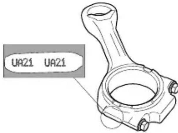
Рисунок 2.28 – Маркування на кришці і шатуні
