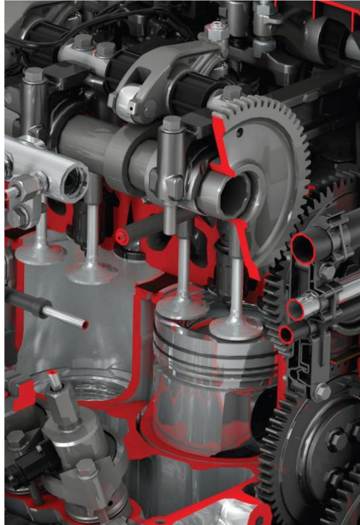
Рисунок 1.6 – Конструкція приводу і ГРМ
