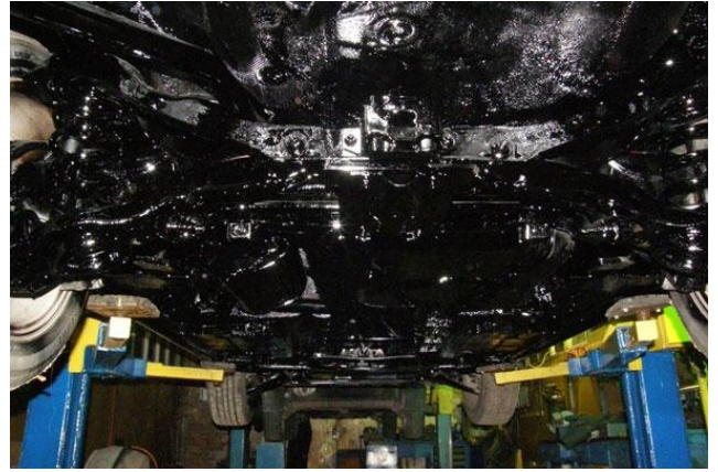
Рисунок 2.4 – Технологія нанесення антикорозійних матеріалів на днище автомобіля
