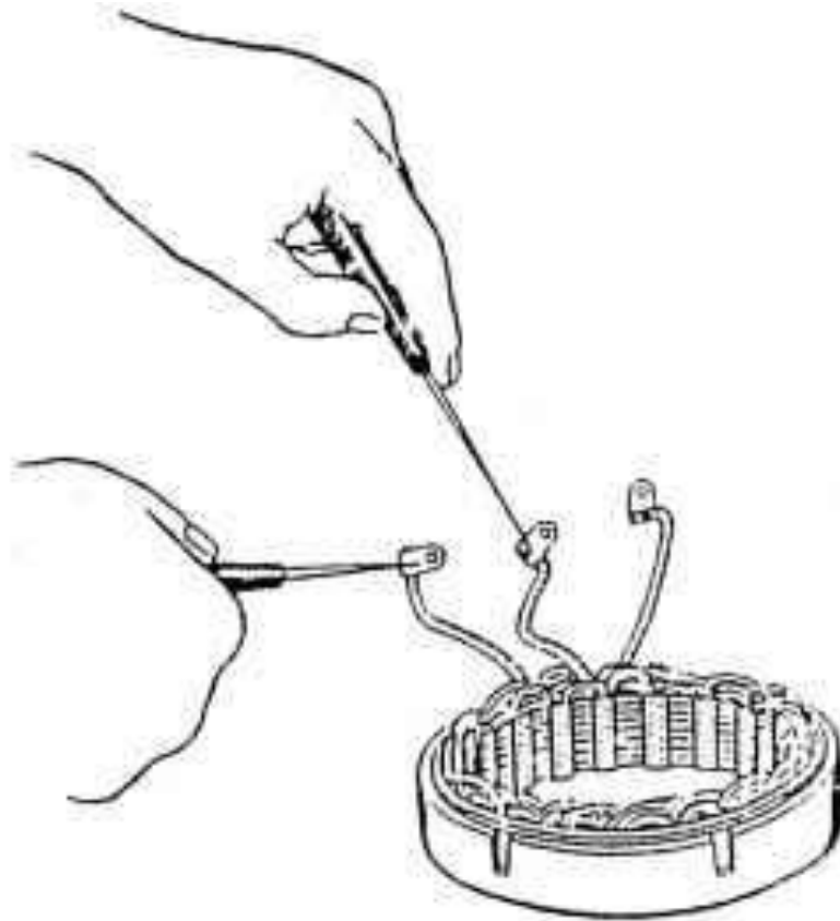
Рисунок 2.7 - Перевірка обмоток статора на обрив ланки
