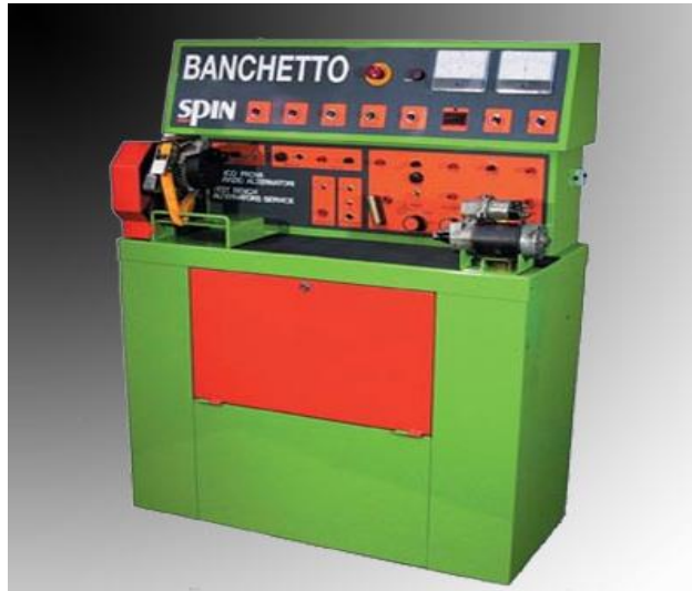
Рисунок 3.2 - Стенд для електрообладнання Vanchetto
