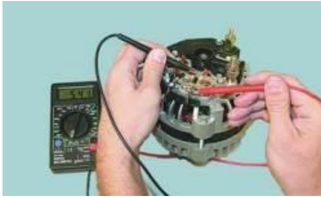
Рисунок 2.27 – Перевірка додаткових діодів
