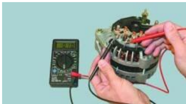
Рисунок 2.29 – Перевірка обмотки статора
