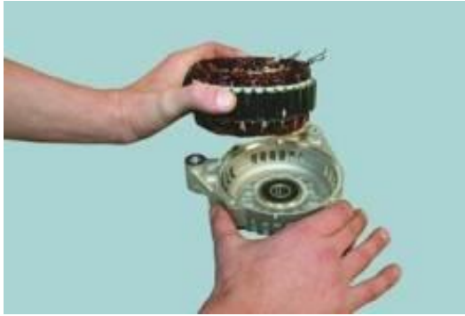
Рисунок 2.58 – Роз'єднання статора і передньої кришки
