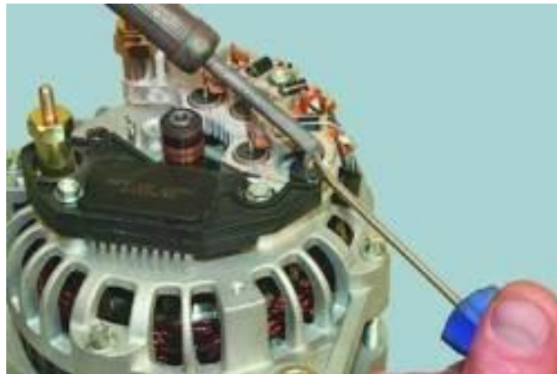
Рисунок 2.31 – Відпаювання виводу РН
