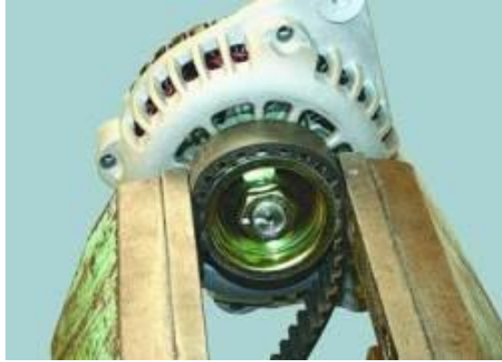
Рисунок 2.47 – Затиснутий шків в лещатах
