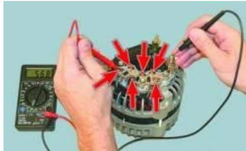
Рисунок 2.25 – Перевірка діодів випрямляча
