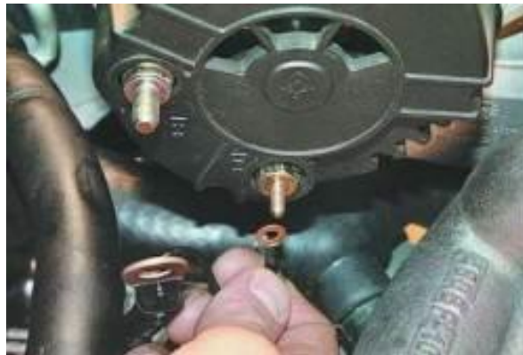
Рисунок 2.5 – Зняття наконечника дроти
