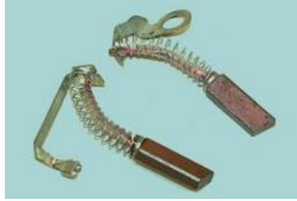
Рисунок 2.22 – Нова та дефектна щітка
