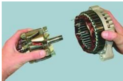
Рисунок 2.51 – Виймання ротора з передньої кришки
