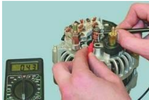
Рисунок 2.23 – Перевірка обмотки ротора
