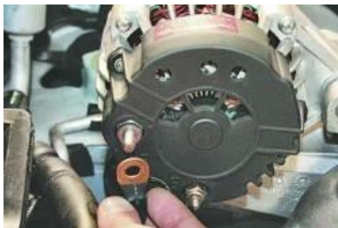
Рисунок 2.3 – Зняття наконечника дроту
