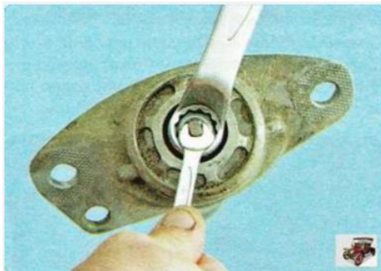
Рисунок 2.23 – Зняття опори з штока амортизатора
