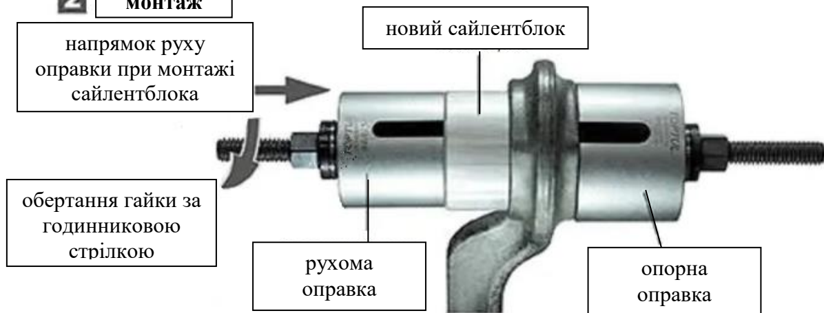
Рисунок 3.3 – Процес роботи з пристосуванням
