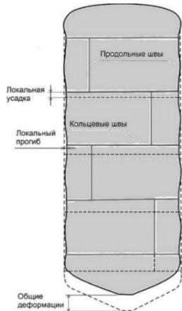
Рис.1. Схема деформацій циліндричної ємності з великою кількістю повздовжніх і кільцевих зварних з'єднань.
