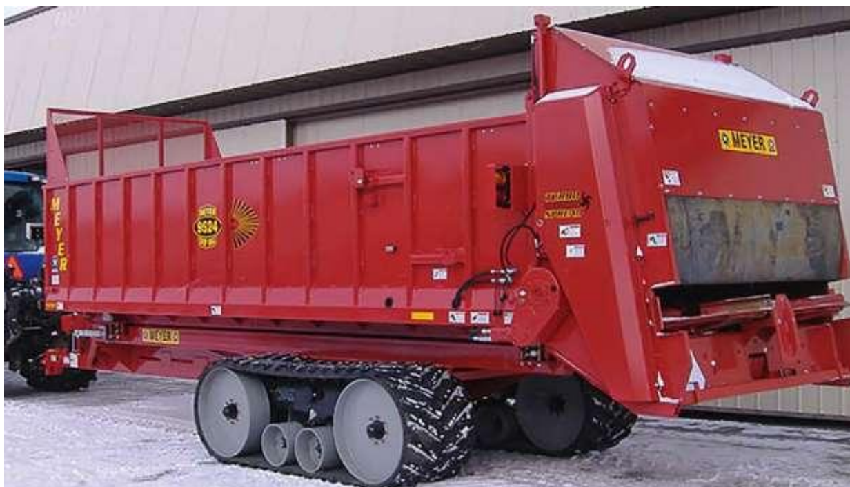
Рисунок 1.5 – Розкидач органічних добрив із гусеничними рушіями моделі Meyer 9524
