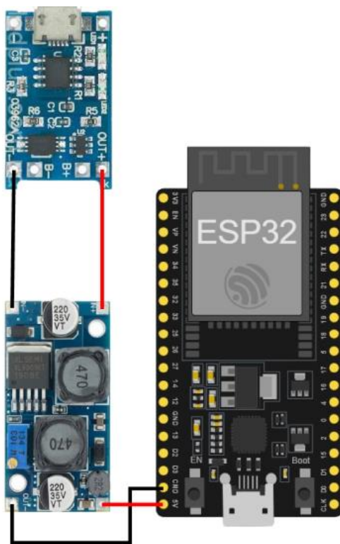
Рисунок 2.11 – Підключення контролера заряду до ESP32
