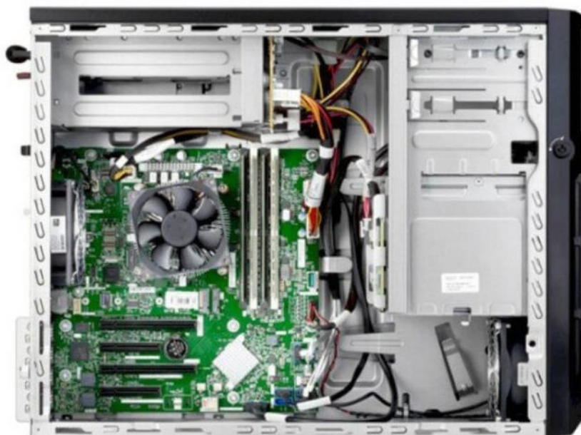
Рисунок 2.3 – Внутрішня будова серверу HP ProLiant ML30 Gen10
