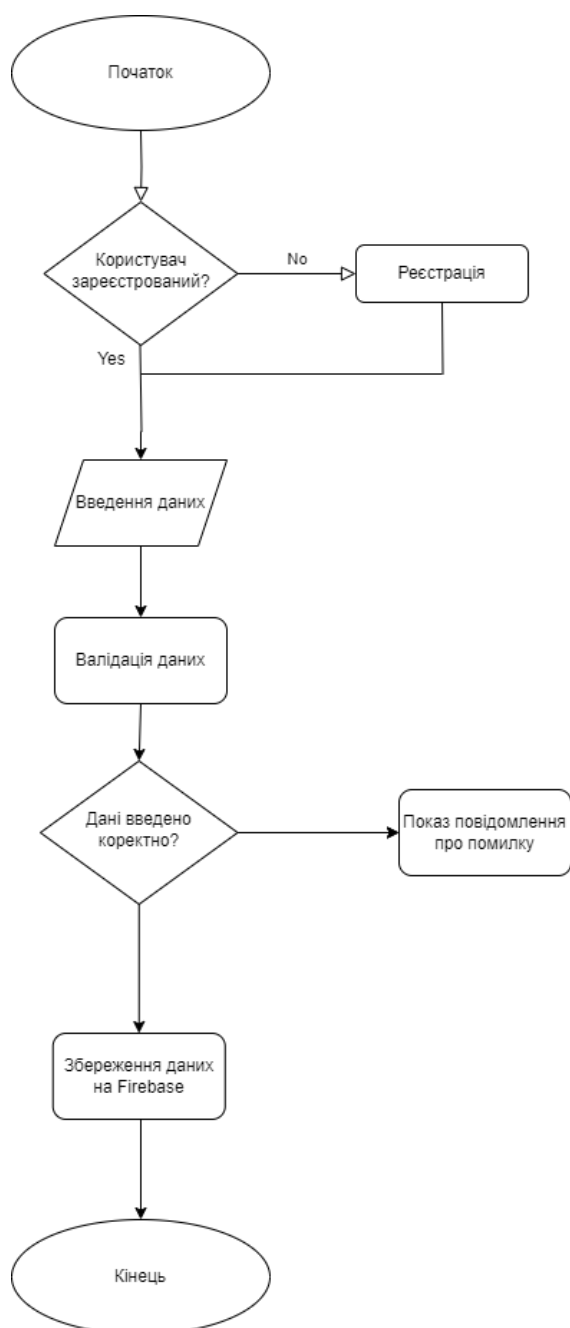
Рисунок А.3 – Алгоритм роботи застосунку
