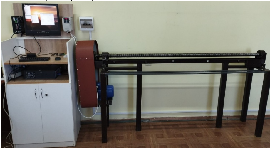
Рис. 2 Стенд управління асинхронним двигуном з допомогою одноплатного комп'ютера Raspberry Pi
