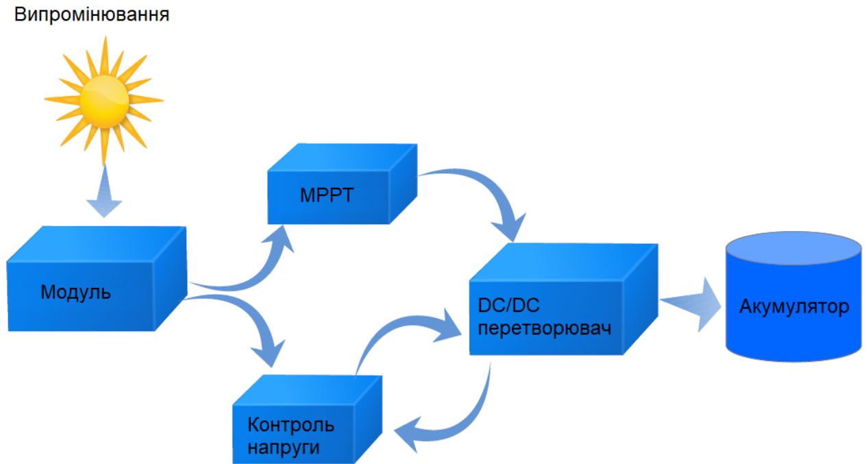
Рисунок 2.5 - Блок-схема фотоелектричного зарядного пристрою
